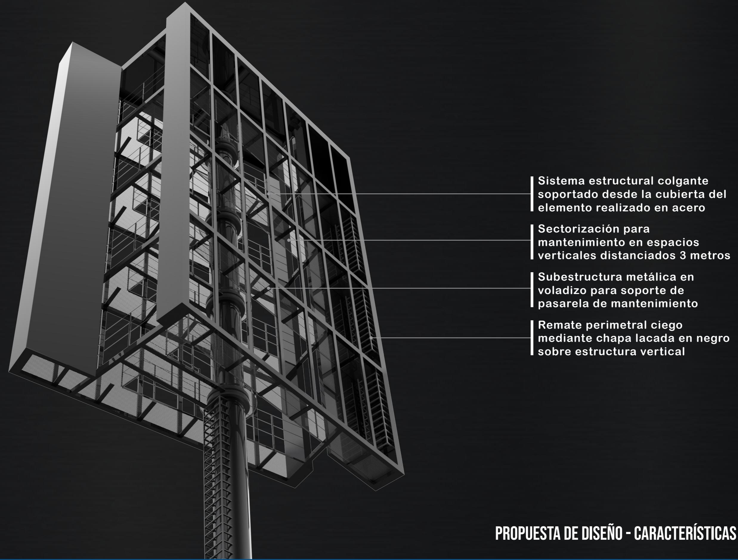
Sistema estructural colgante soportado desde la cubierta del elemento realizado en acero
